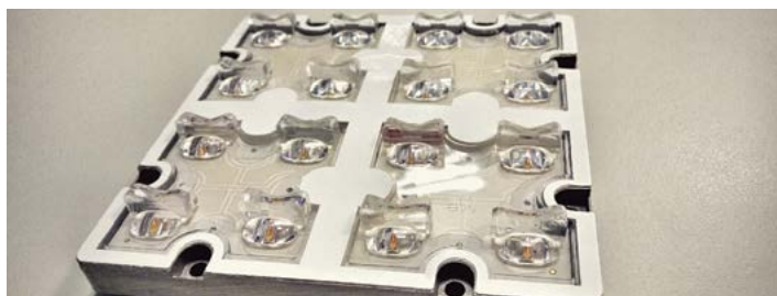
Рисунок 1. 16-светодиодная матрица М-класса производства VS Lighting Solutions содержит четыре вторичных линзы, изготовленных из пластичного силикона DOWSIL™ MS-1002 и герметизированных с помощью прозрачного клея DOWSIL™ 3140.
